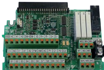
Клеммная панель L1000A
